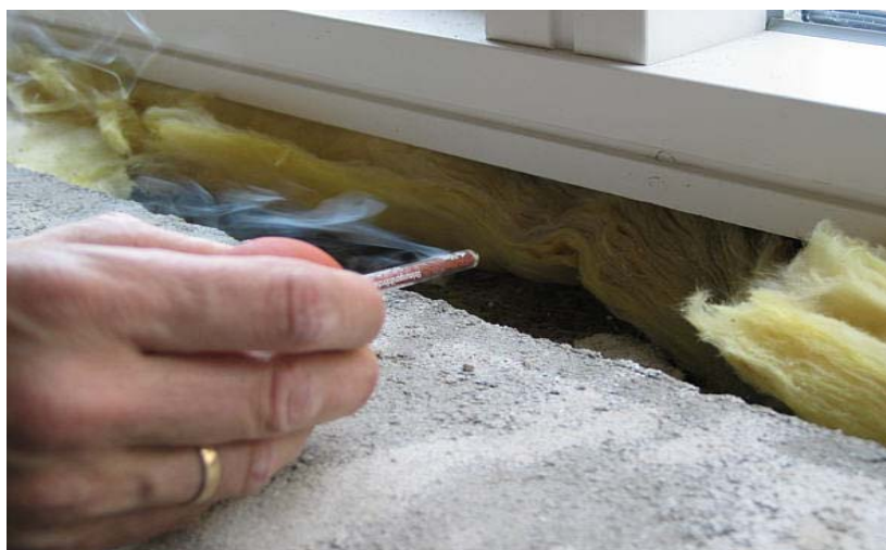
Figur 2: Eksempel på registrering af en hvid røgs bevægelse i testning af lufttæthed.
